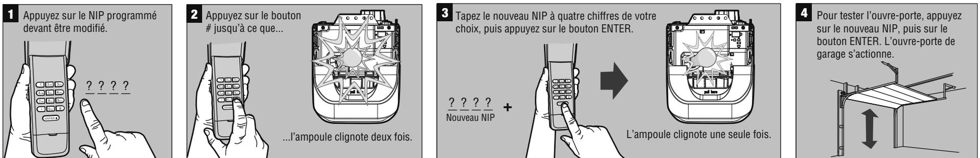
\* Lorsqu'un ouvre-porte de garage est équipé d'un bouton LEARN vert ou d'un récepteur extérieur, reprenez l'étape « Programmation du NIP initial » pour modifier le NIP existant.
