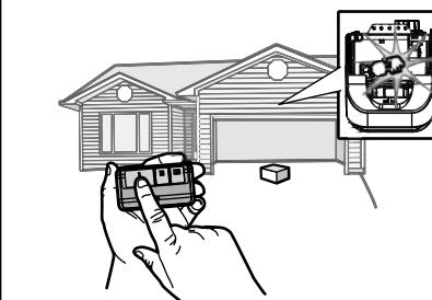
L'ouvre-porte de garage ne se fermera pas à l'aide d'une télécommande si le témoin DEL d'un des deux capteurs d'inversion est éteint (ce qui avertit que le détecteur est mal aligné ou obstrué).
