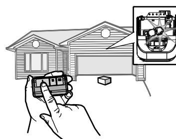
El abre-puertas de garaje no se cerrará mediante un control remoto si el LED del sensor de reversa de seguridad está apagado (alertándolo de que el sensor está mal alineado u obstruido).
