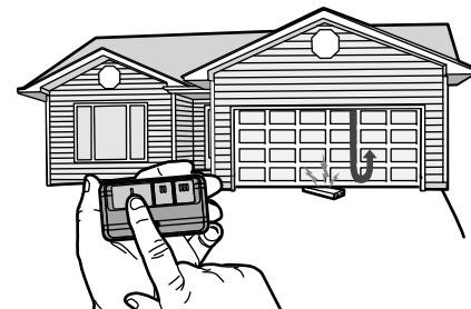
Si la puerta se detiene y no retrocede al hacer contacto con la obstrucción, se debe ajustar la carrera (consulte el paso 1 de la sección Ajustes).
