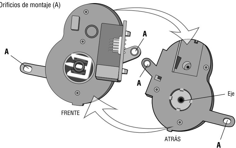
**2.1** Instalar el módulo nuevo alineando el eje con el motor.
