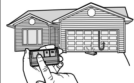
Si la porte s'arrête et ne remonte pas en raison de l'obstruction, sa course doit être ajustée (voir l'étape de Réglage n° 1).
