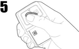
**5** Sélectionner un bouton pour programmer. Appuyer \_\_\_ fois sur le bouton en vous assurant que LED arrête de clignoter après chaque pression. Le code est accepté lorsque l'une des choses suivantes se produit :
