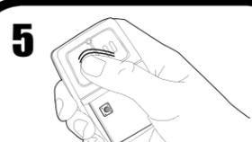
**5** Sélectionner un bouton pour programmer. Appuyer \_\_\_ fois sur le bouton en vous assurant que la LED arrête de clignoter après chaque pression. Le code est accepté lorsque la porte s'actionne.
