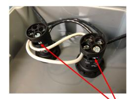
CONNECT HOT WIRE FROM EACH SOLENOID TO LOCATION 21 ON THE PUSH BUTTON. EACH SOLENOID WILL BE CONNECTED TO ONE PUSH BUTTON.
