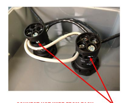
CONNECT HOT WIRE FROM EACH SOLENOID TO LOCATION 21 ON THE PUSH BUTTON. EACH SOLENOID WILL BE CONNECTED TO ONE PUSH BUTTON.
